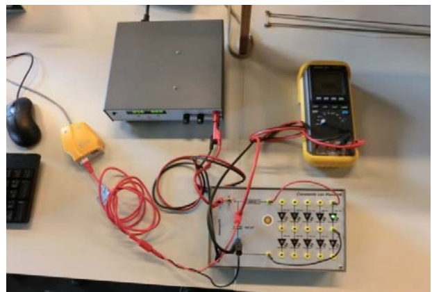
Figuur 2b: Meetkastje aangesloten op €Lab, spanningsbron en multimeter
