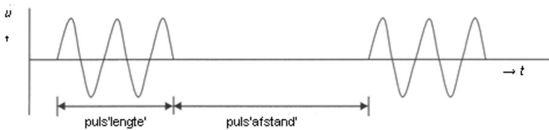
Figuur 3: Het u,t -diagram van het door de zender/ontvanger-combinatie uitgezonden geluidssignaal, met daarin aangegeven de tijd die verloopt tijdens het uitzenden van een geluidspuls (de puls' lengte') en de tijd die verloopt tussen het uitzenden van twee opeenvolgende geluidspulsen (de puls' afstand').
