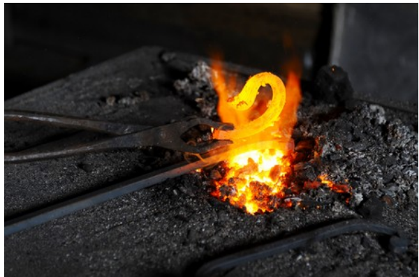
Figuur 1: Smid merkt op dat het hete ijzer dezelfde kleur krijgt als de kolen.
